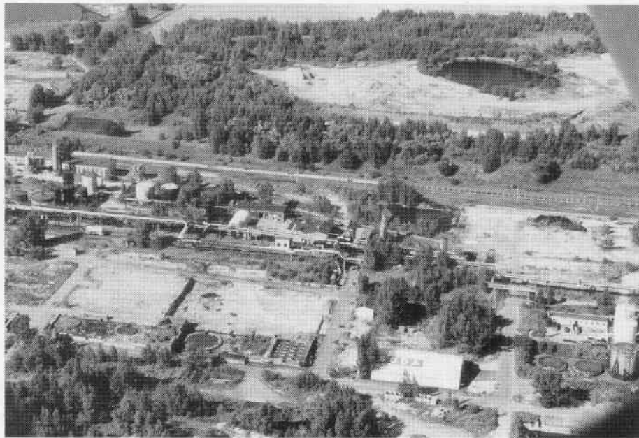
1: Blick auf das ehemalige Teerverarbeitungswerk Rositz mit Zelt für die Pilotanlage zur mikrobiologischen Sanierung. Im Hintergrund zwei Teerseen
