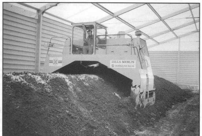
2: Erdumsetzmaschine beim Aufsetzen der Mieten
